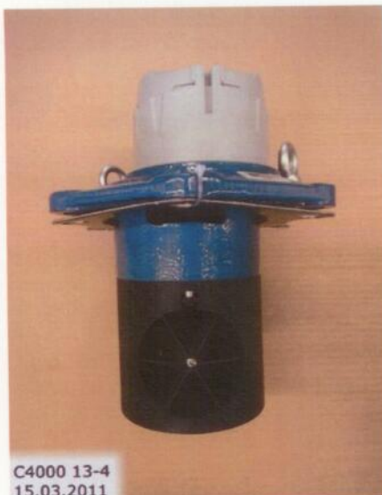
C4000, austauschbare metrologische Einheit, Ansicht der Anströmseite mit integriertem Strahlkreuz
