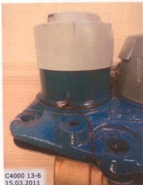
C4000, austauschbare metrologische Einheit, Drahtsicherung kleinerer Zähler gegen Deckel
