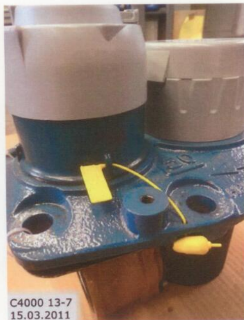
C4000, austauschbare metrologische Einheit, Kunststoffsicherung kleinerer Zähler gegen Deckel
