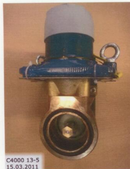
C4000, austauschbare metrologische Einheit, Ansicht der Abströmseite mit Ventilgehäuse
