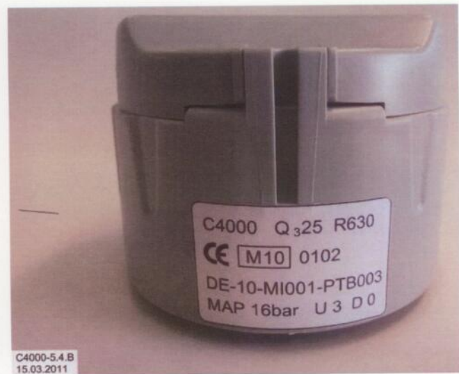
C4000, induktives Zählwerk, Schnapphaube mit Bezeichnungsschild
