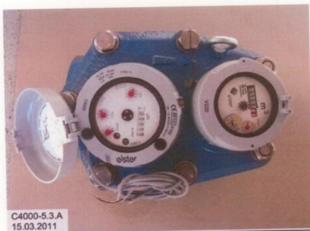
C4000; Multipulse-Dosenzählwerk (2/3 Zeiger) mit Reedkontaktschalter, Draufsicht
